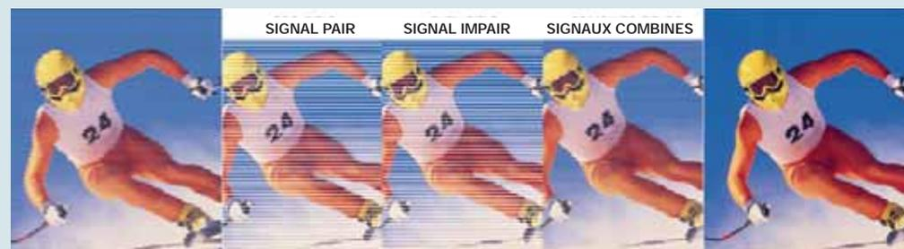
L'entrelacement vidéo traditionnel envoie séparément les signaux pairs et impairs pour une meilleure résolution avec un minimum de bande passante
