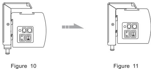
Pour éviter de que le moteur ne surchauffe, ne faites pas dérouler/enrouler l'écran pendant plus de 4 minutes de façon continue. Si le moteur a surchauffé, attendez au moins 2 minutes pour qu'il se refroidisse. Le moteur n'a pas besoin de lubrifiant. Les limites d'ouverture et de fermeture de l'écran ont été pré-réglées en usine pour une configuration optimale. Veuillez contacter votre revendeur local ou un professionnel si vous voulez ajuster les réglages, pour éviter d'endommager le moteur.
