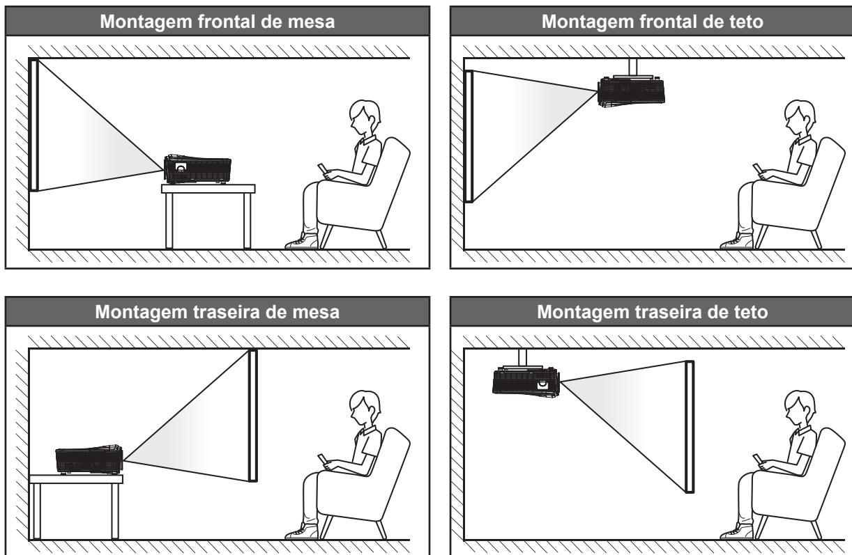
O projetor deve ser colocado em uma superfície plana e 90 graus/perpendiculares à tela.
