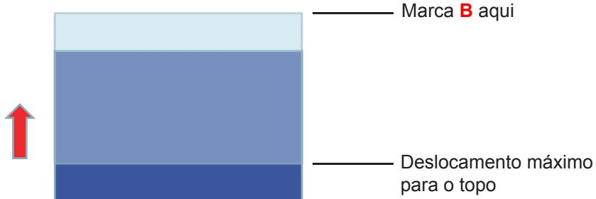
4. Meça a distância entre Marca A e Marca B, em seguida, dividir por 2 e posicionar a imagem de volta para Marca A/B para a base. A imagem estará no centro de seu deslocamento Vertical.
