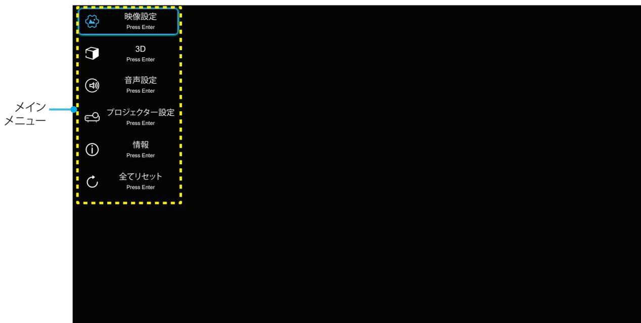
2. OSD が表示されたら、**▲▼** キーを使ってメインメニューの任意の項目を選択します。特定のページを選択し、リモコンの入力またはプロジェクターのキーパッドの **←** を押して、サブメニューに進みます。
