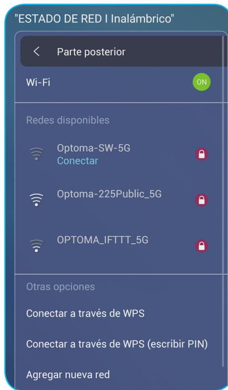
**Nota:** En la lista de **Otras Opciones**, puede ajustar configuración de red inalámbrica adicional, como la conexión a través de WPS, añadir una nueva red y ajustar la configuración de punto de acceso portátil.
