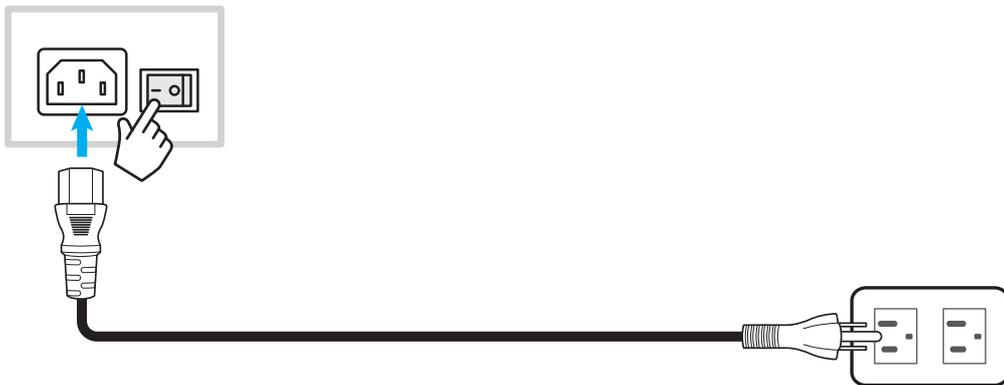
Presione el botón **Alimentación** para encender el IFP. El indicador LED se ilumina en color azul, lo que significa que el dispositivo está preparado para utilizarse.
